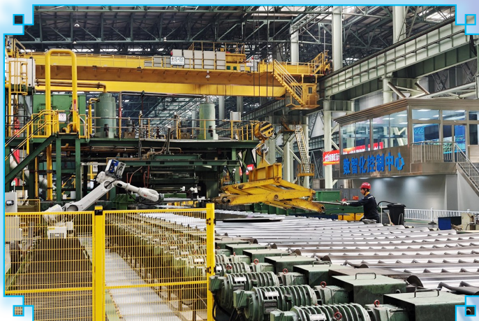
图为机器人手臂在东轻生产车间检测铝板厚度。吴士强 摄
